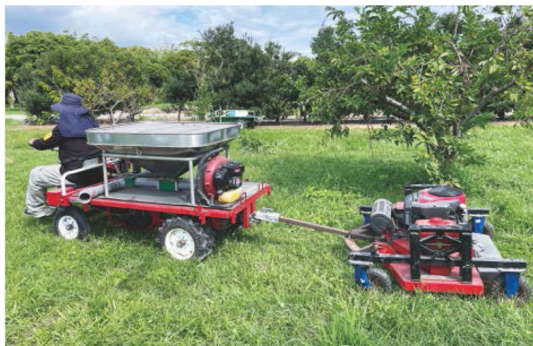
圖7. 搬運車同時搭載附掛式施肥撒布裝置與附掛式割草裝置進行施肥與割草作業
