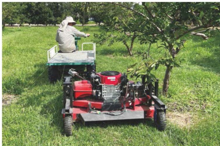
圖6. 附掛機構向一側偏移，使刀盤側移約60公分，可深入果樹冠下。
