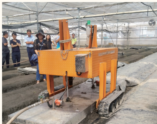
■ 臺南區農業改良場開發自走式土壤蒸汽消毒機，可改善連作障礙，蒸汽消毒後須以塑膠布覆蓋，以維持溫度
