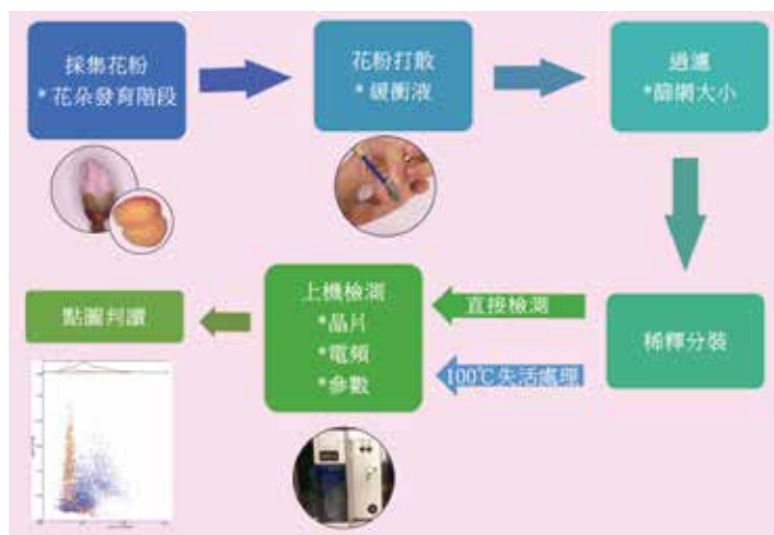
圖四、利用電阻抗流式細胞儀(IFC)檢測濶花粉活力之流程。*影響檢測結果之主要因子。
