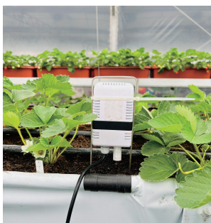
▲圖 8. 利用溫濕度及二氧化碳濃度感測器，監控溫室微氣候環境。
