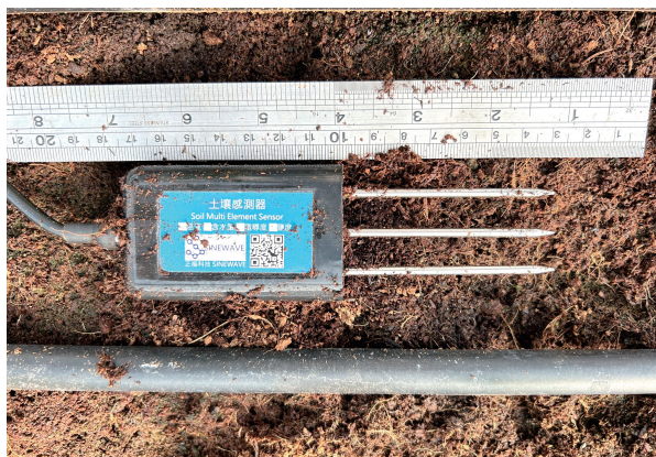
▲圖 6. 監測土壤水分及電導度感測器，作為水分及養分管理參考。
