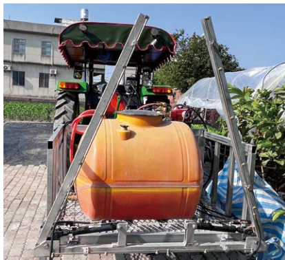
圖五、框式噴藥機附掛於曳引機後方可放置藥桶及高壓噴霧機
