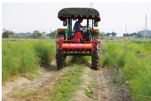
圖三、蘆筍碎枝機刀軸搭配槌刀運轉時可將母莖碎除
