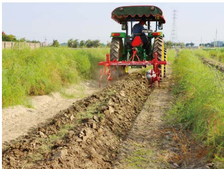
圖十、由曳引機帶動中耕培土機的犁片將兩側土壤向中間集中，達到培土的效果
