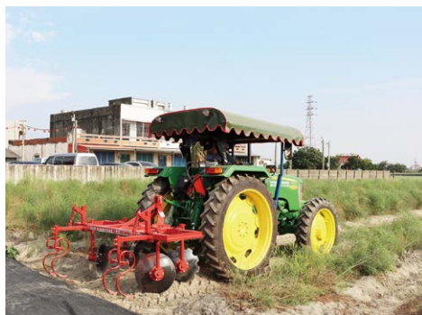
圖九、中耕培土及彈簧耙鬆土機主要由犁片與彈簧耙所組成
