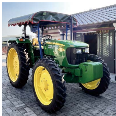
圖一、John Deere 5055E曳引機配合改裝高腳輪以利於蘆筍田間行進
