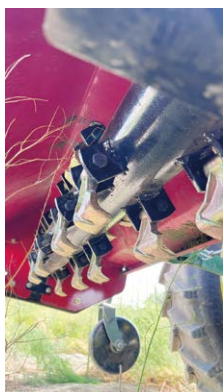
圖二、蘆筍碎枝機刀軸搭配槌刀運轉時可將母莖碎除
