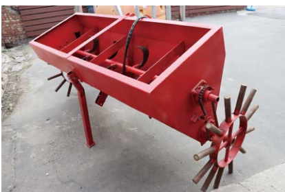
圖七、有機肥灑肥機由儲料槽、調節閥門、太陽輪與攪拌葉片組成
