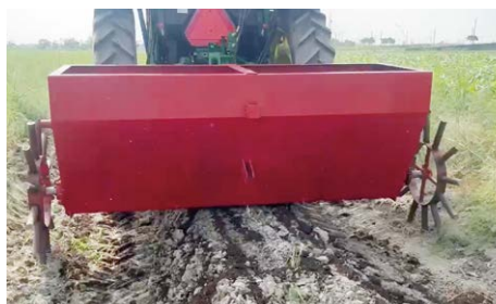
圖八、曳引機行進時同步帶動太陽輪轉動，將有機肥均勻帶狀撒布於畦面
