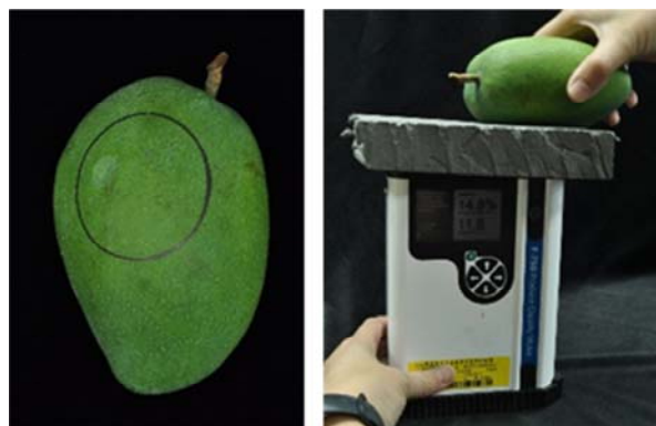
圖一、芒果果實量測部位標示及使用 F-750 近紅外光果實品質測定儀測量方式。
