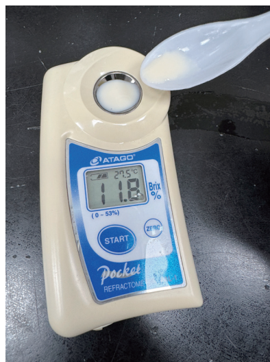
▲圖 7. 糖度計常用於作為豆漿濃度粗估工具。
