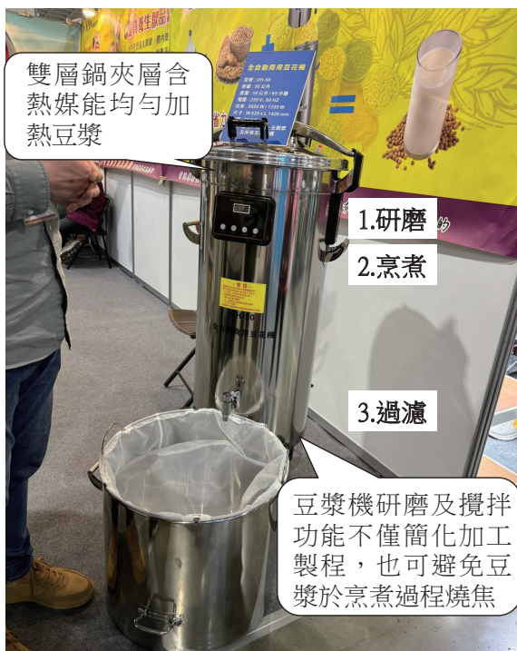
▲圖 4. 超商豆漿使用機械化生產製程 A 及製程 B 皆有相對應之生產機型。
