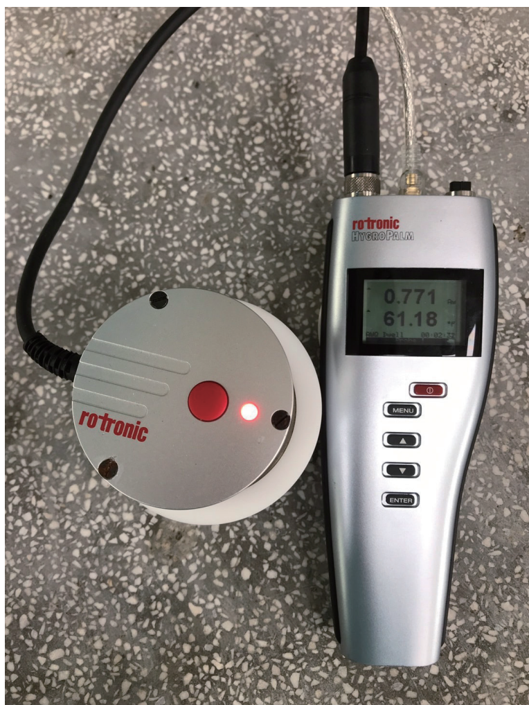
▲圖 12. 以水活性分析儀分析黑糖薑片水活性符合常溫貯藏條件。
