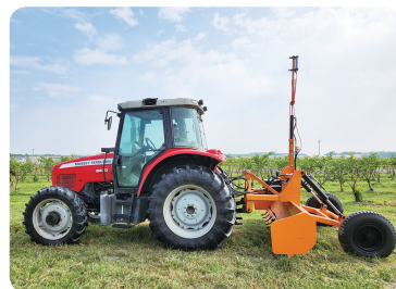
圖1. 附掛式雷射整平器
