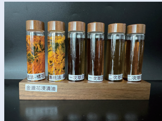
▲圖 3. 新開發超音波水浴萃取技術之萃取效率（左 3 至 6）高於傳統製程（左 1 至 2）。
