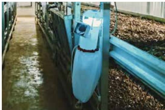
圖二、菇舍智慧型LED燈滅蟲模組。
