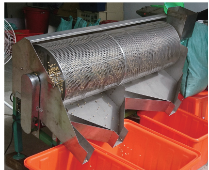
圖 25. 大豆粒徑分級機外觀與作用情形。
