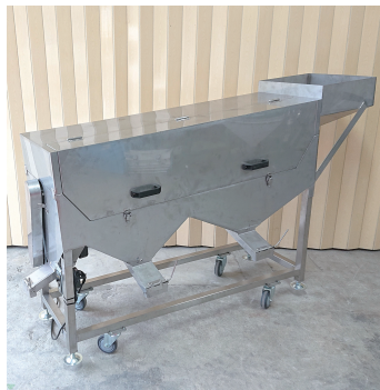
圖 25. 大豆粒徑分級機外觀與作用情形。
