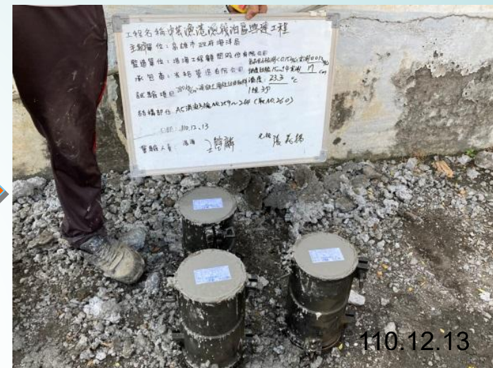
混凝土試體取樣
