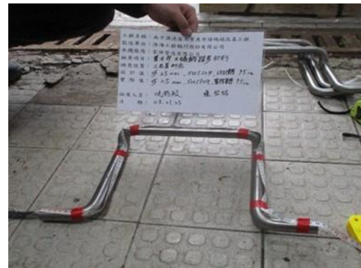
▲不鏽鋼踏步材料進場尺寸查驗
