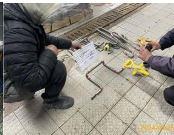
▲不鏽鋼踏步材料查驗取樣
