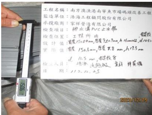
▲PVC止水帶材料進場尺寸查驗
