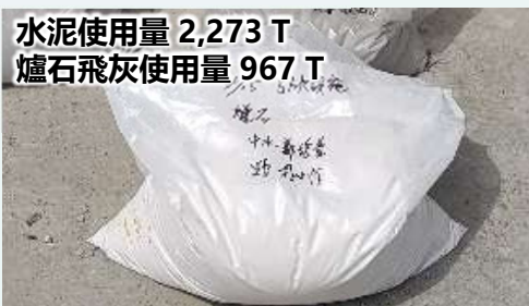
爐石、飛灰替代率30%
