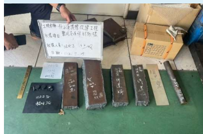
盤式支承金屬材料取樣
