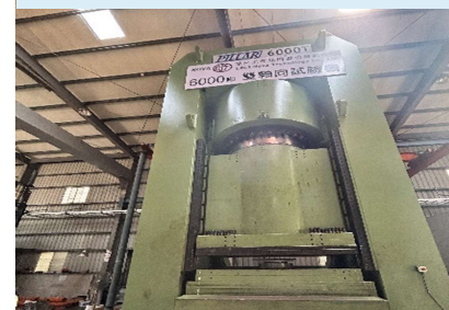
盤式支承载重試驗
