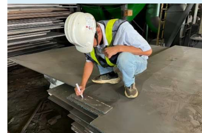
鋼構渡槽金屬材料取樣
