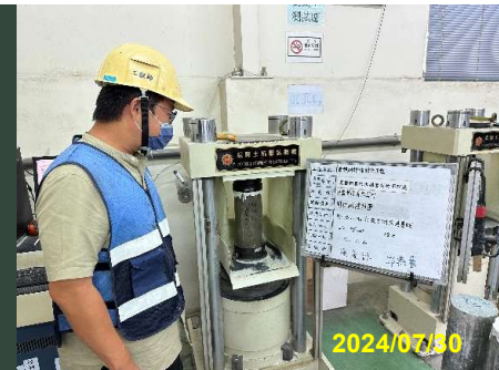
混凝土抗壓試驗
