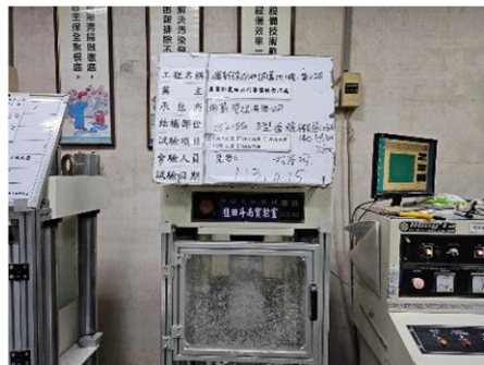
混凝土抗壓試驗
