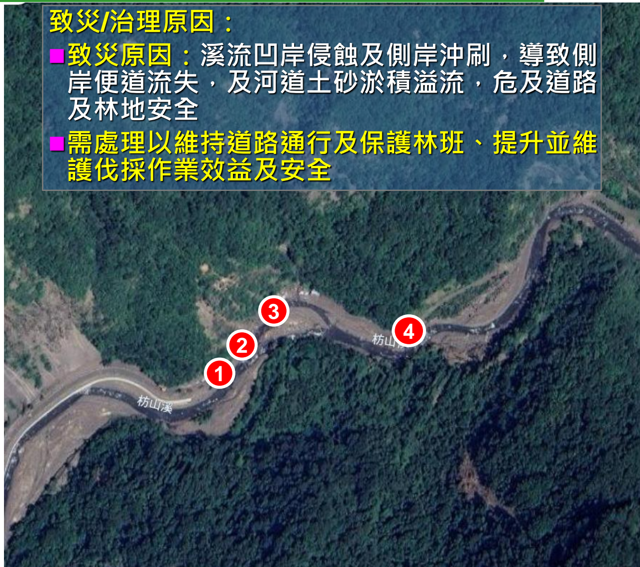
2 土砂淤積，影響通洪斷面
