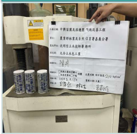
鑽心試體抗壓試驗
