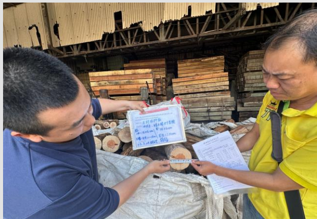
矮木樁埋設木樁查驗
