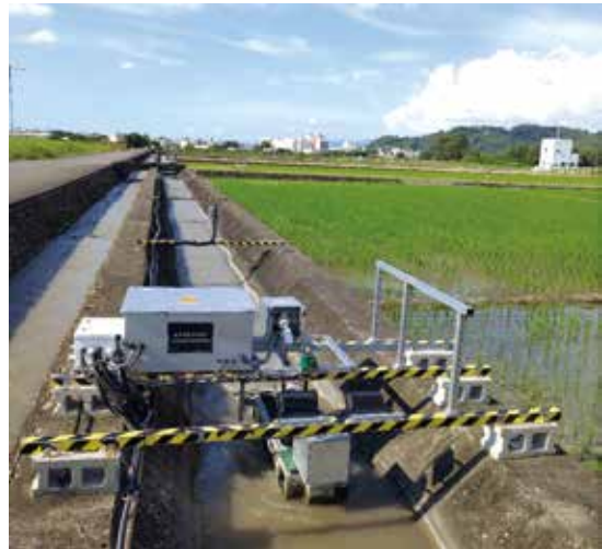
圖一、阿基米德式微水力發電系統。
