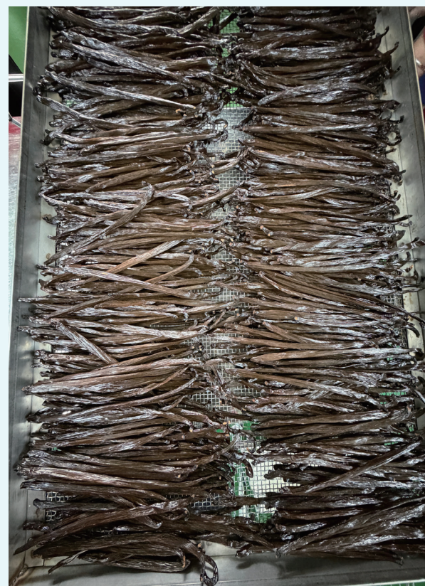
▲圖 4. 香草莢在環控設備下進行乾燥製程。
