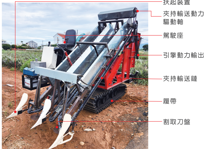
圖1. 鳳梨植株採收機的各项構造
