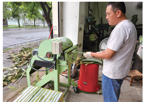
圖5. 鳳梨葉片抽纖機作業情形
