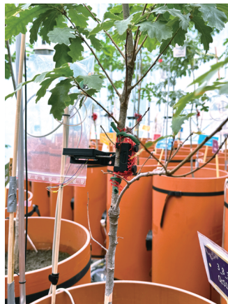
圖4. 研究所內及時樹徑量測系統
