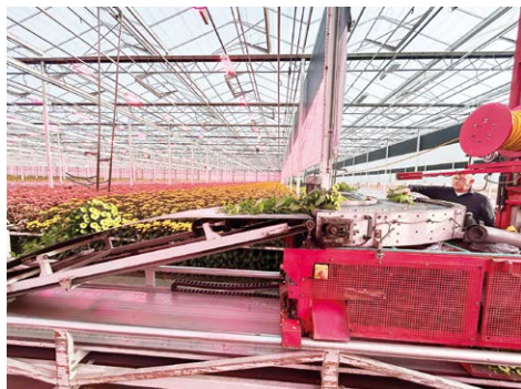
圖五、Leen Middelburg Chrysanten導入切花菊田間自動化採收運輸設備 (左) 及自走式天敵昆蟲施放裝置 (右)
