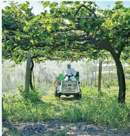
▲ 電動鼓風噴霧機於葡萄園作業情形，鼓風系統將霧化藥液吹送至棚架冠層各部位，提升植株葉幕層之覆蓋均勻度，適用於葡萄等棚架型果樹之植物保護作業
