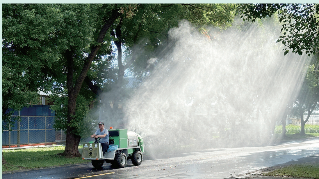
▲電動鼓風噴霧機實際作業情形，機具噴霧有效覆蓋寬度達 9 公尺、高度達 6 公尺，適用於果樹園區植物保護作業效果，兼具低碳、低噪音與省工優勢
