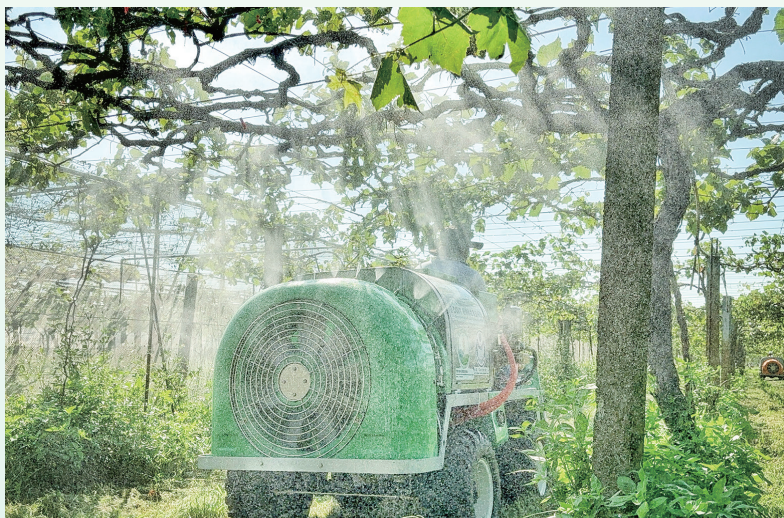
▲ 電動鼓風噴霧機於葡萄園作業情形，鼓風系統將霧化藥液吹送至棚架冠層各部位，提升植株葉幕層之覆蓋均勻度，適用於葡萄等棚架型果樹之植物保護作業
