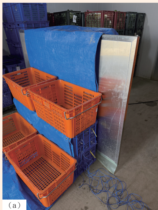
▲圖 1. 壓差預冷操作方式。(a) 採用側吸式壓差預冷機，葉菜塑膠籃放壓差預冷機抽風口兩側（若另一側塑膠籃內無葉菜，可放塑膠布於塑膠籃側邊擋風即可），(b) 蓋上防風布確認其緊貼塑膠籃，避免漏風，並開始抽風預冷。
