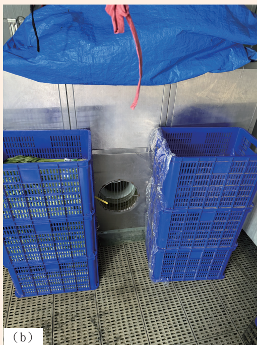
▲圖 1. 壓差預冷操作方式。(a) 採用側吸式壓差預冷機，葉菜塑膠籃放壓差預冷機抽風口兩側（若另一側塑膠籃內無葉菜，可放塑膠布於塑膠籃側邊擋風即可），(b) 蓋上防風布確認其緊貼塑膠籃，避免漏風，並開始抽風預冷。
