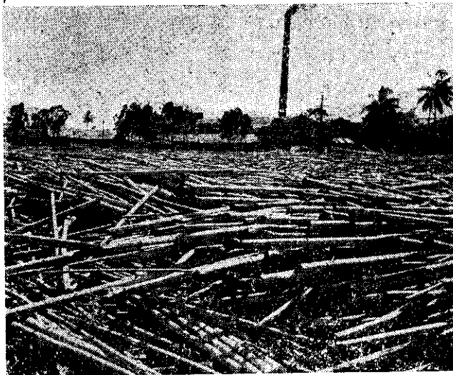
每個紙廠，都需要一個面積相當大的原料堆積場，很不經濟。竹材如先壓成竹絲，再經打包，就可以節省堆積地位，同時減少腐朽的損失。
