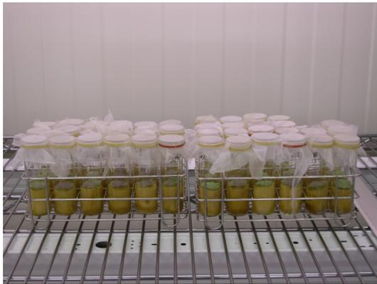
圖 21. 將試驗蚜蟲放入生長箱內，24 小時後取出觀察蚜蟲對殺蟲劑的反應。
