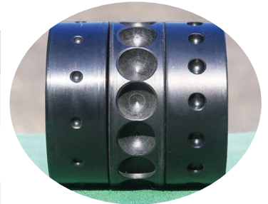
不同孔徑和孔數的播種輪，左-12(莧菜、十字花科)，中-14孔(蕹菜)，右-15孔(菠菜、高苣)
