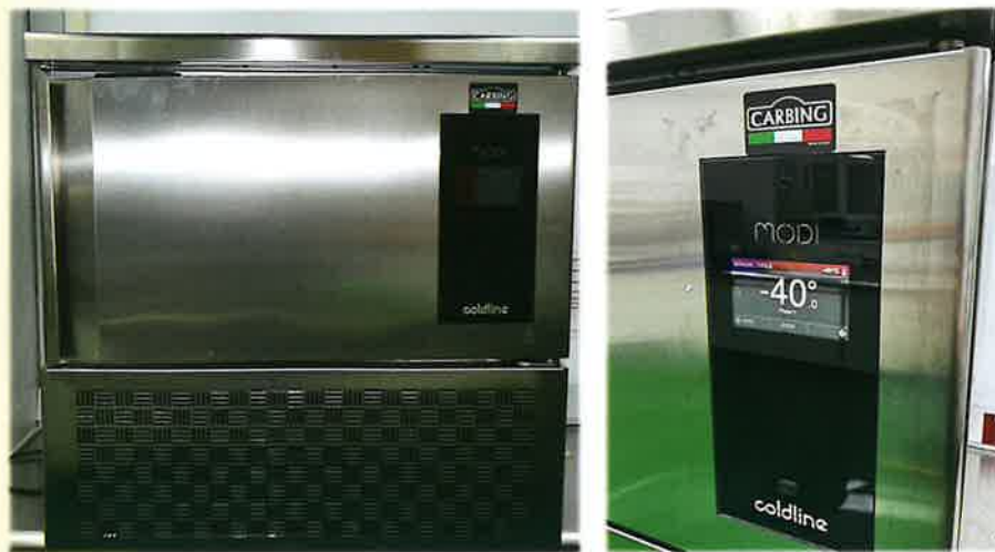
氣冷式批量急速冷凍機，冷凍環境可達零下40°C。
