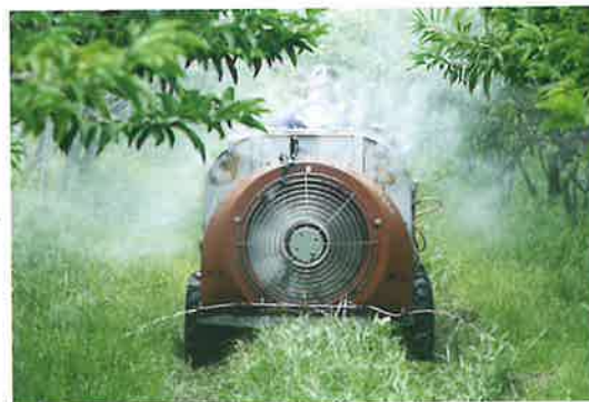
以噴藥車進行有機液肥之葉面噴施(左)與地面根圈澆灌(右)作業
