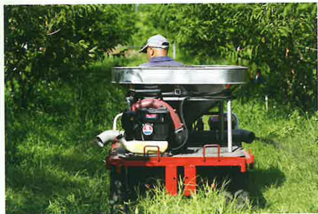
使用肥料撒布機進行固態有機質肥料全園均勻撒布作業
