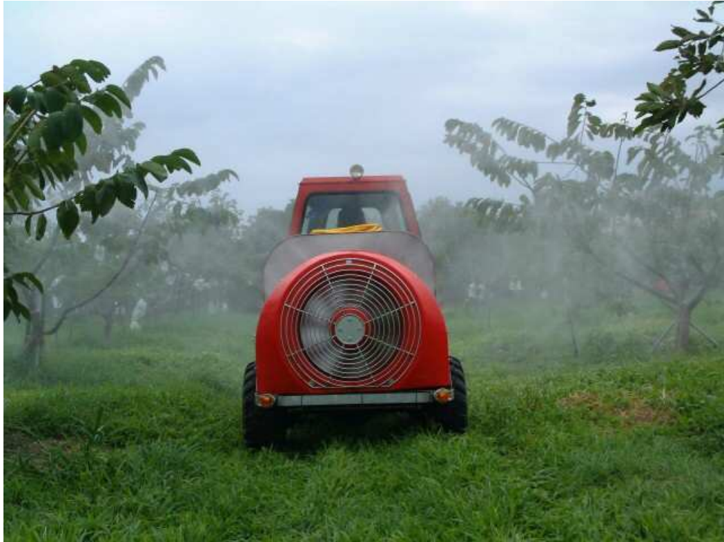
圖 3. 保護罩自走式鼓風噴霧車果園噴藥，撒布藥液霧化並具動能穿透力
