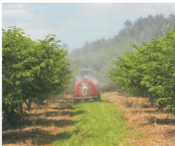
圖9.鼓風式靜電噴霧車撒布霧粒細化
