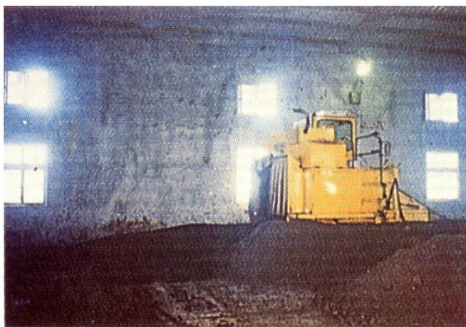
圖 4. 台糖公司之堆肥場—全場密閉式配合行走式堆肥翻堆機，實際處理豬屍體與豬糞，堆肥化情形 (洪，1999)。
