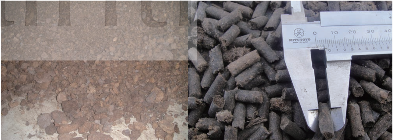
左：水車式固液分離之固形物乾燥產品；右：逕流式固液分離之固形物乾燥造粒產品。
