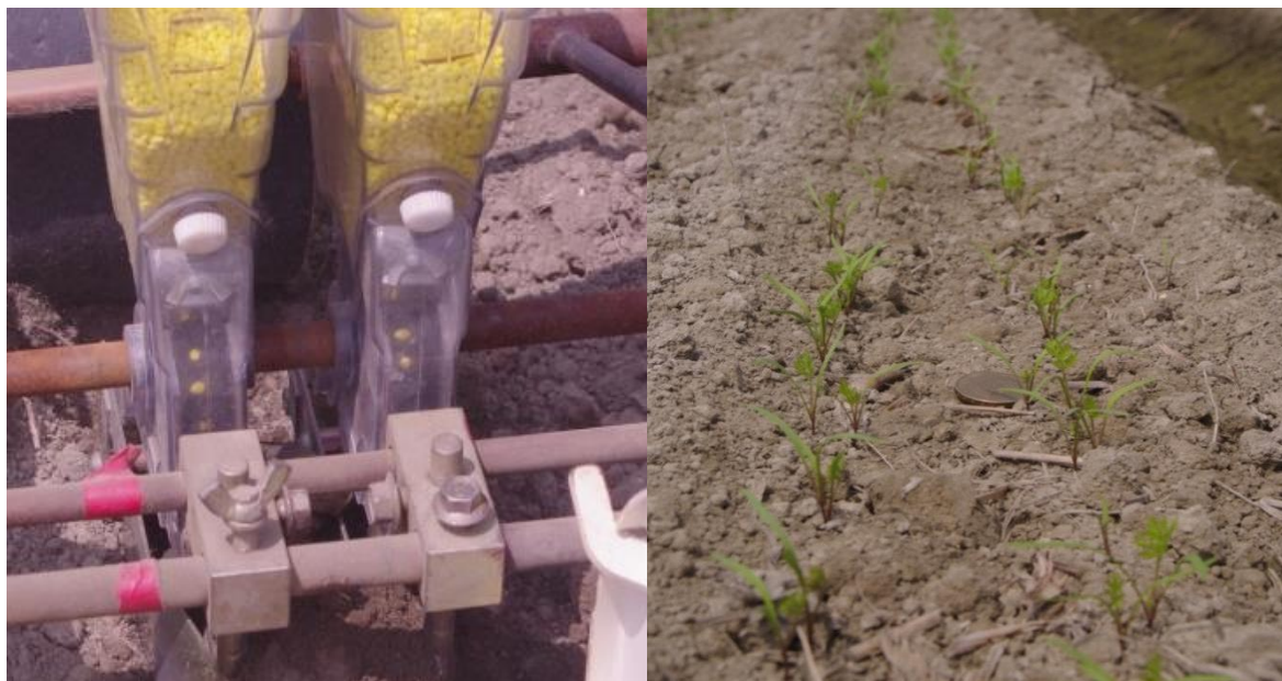
圖 3. 種子造粒後可配合機械在田間直接進行點播。
