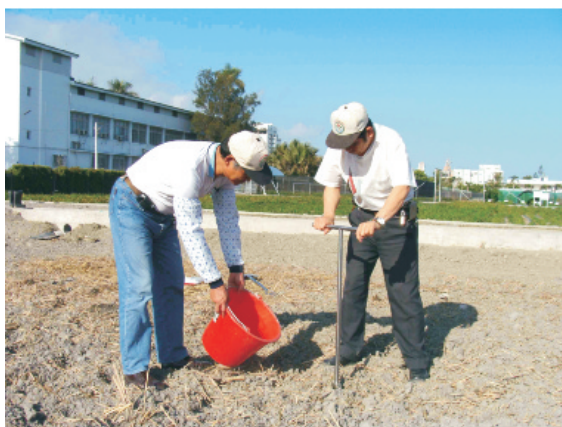
圖2. 本場製作土壤採土器，並放置於農會供農友使用，右為採土器使用方式。
