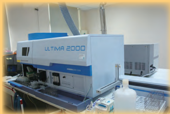
▲實驗室內儀器設備齊全，例如感應耦合電漿原子發射光譜儀，可快速分析樣品中各種元素的含量
