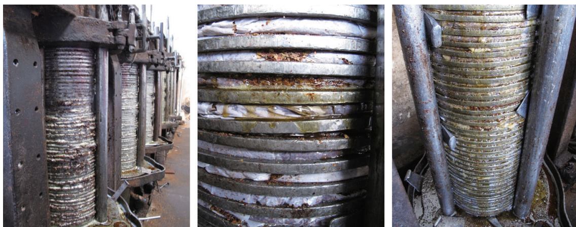
餅式榨油機。左圖為茶餅放置後的情形。中圖為剛開始加壓，苦茶油從茶餅流出的情境。右圖為持續加壓，更多苦茶油流出的情形(吳家禎 攝)
