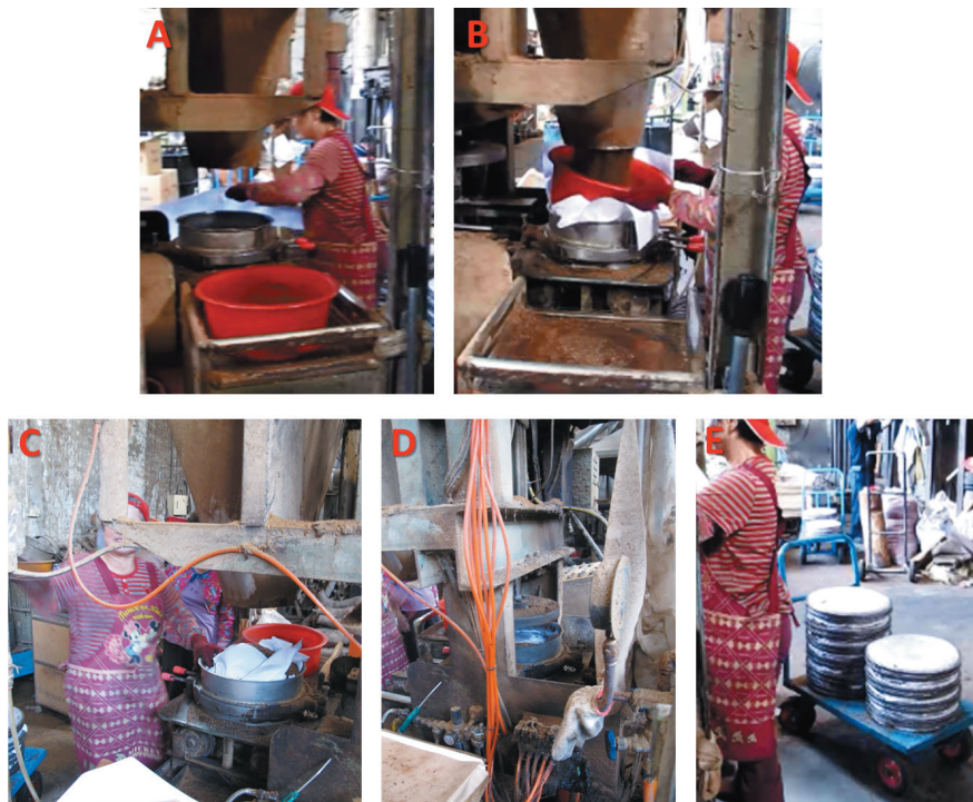
餅式榨油法製餅過程。A-E分別為：A架設邊框、B茶籽進料、C紙張包覆、D重壓製餅、E完成取餅(吳家禎 攝)
