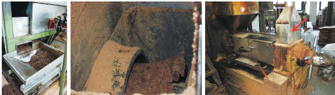
左圖為烘培後的茶籽進入輸送帶後的情形。中圖為螺旋式軸心的末端，深黑色的部分為螺旋軸。右圖為螺旋榨油機的外觀，下方即可壓榨出油；紅色箭頭處打開即為中圖內部照片(吳家禎 攝)
