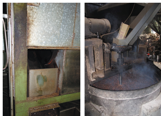
左圖為螺旋式壓榨的烘焙鍋爐，可以明顯看到中間加熱的焰心。右圖為餅式壓榨的炒焙鍋爐。兩者在加熱時皆同時攪拌，使茶籽受熱均勻(吳家禎 攝)
