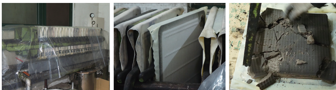
左圖為過濾機台全貌。中圖為過濾板與過濾布。右圖為正在進行油脂過濾程序，進行換版清洗油渣，灰色塊狀物為過濾下來的油渣(吳家禎攝)
