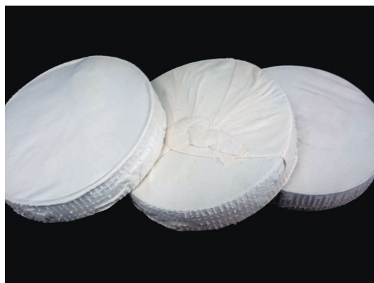
粗碎之油茶籽種仁經水蒸後，製成圓餅狀，以進行餅式榨油(徐光平 攝)
