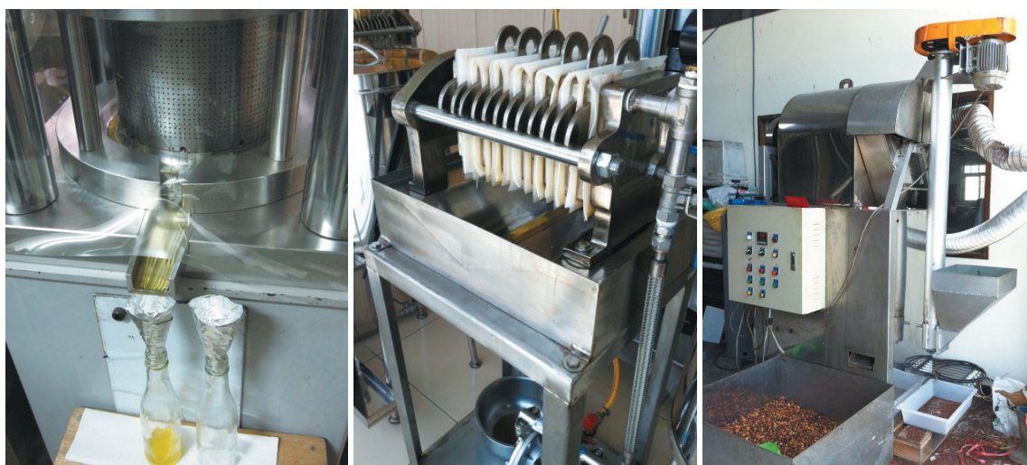
圖左：直壓式榨油機之榨油情形。圖中：所得油品需經沉澱及過濾機處理。圖右：種籽榨油前需經炒焙以除去多餘的水份 (許富蘭 攝)
