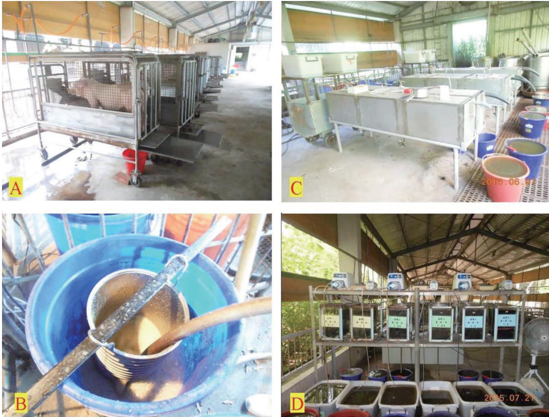
圖 1. 廢水處理流程。A：糞尿收集；B：固液分離；C：厭氧處理；D：好氣處理。
