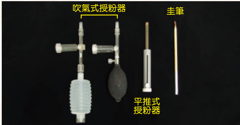
圖2. 鳳梨釋迦授粉器。由左至右為吹氣式授粉器(塑膠吹球及橡皮吹球)、平推式授粉器及圭筆
