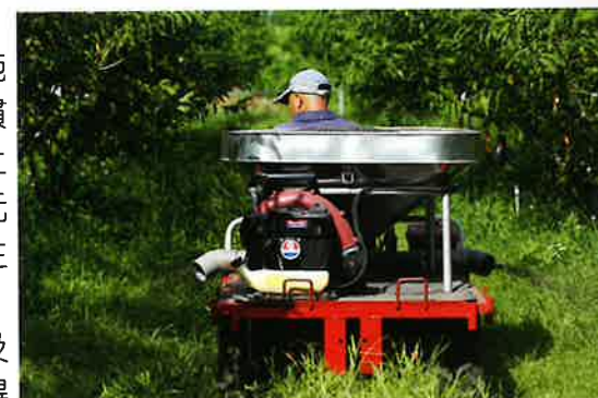
適時適量施用有機質肥料可提高並穩定果園土壤有機質含量(圖為應用本場研發的動力施肥機進行有機肥全園撒佈)
