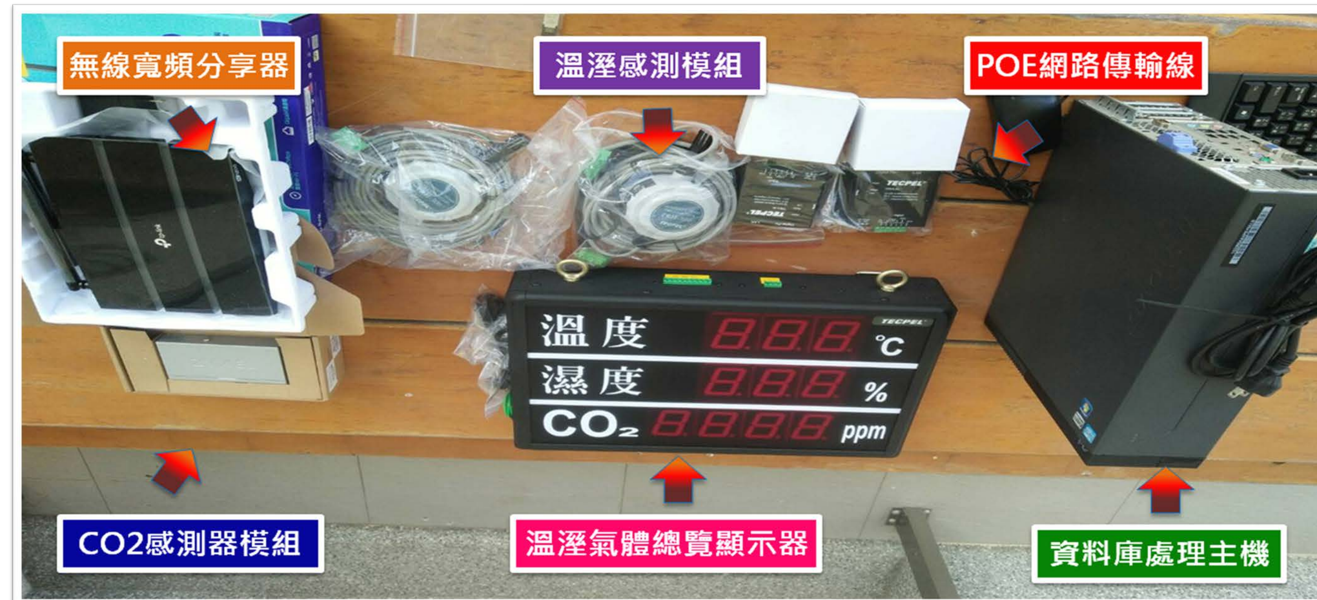
圖1. 建置於八五山養雞示範戶之智慧禽舍環境感測系統各式組件(上圖左) 溫、濕度及 \text{CO}_2 感測器現場裝設(上圖右)
