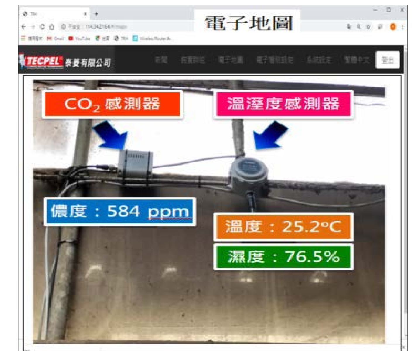
圖1. 建置於八五山養雞示範戶之智慧禽舍環境感測系統各式組件(上圖左) 溫、濕度及 \text{CO}_2 感測器現場裝設(上圖右)
