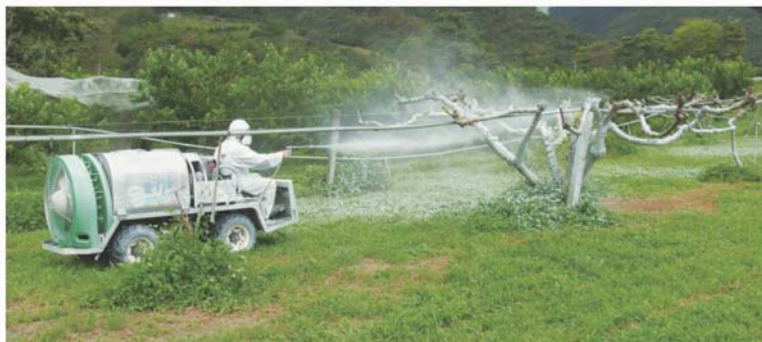
圖6. 噴藥車以手持噴槍噴施輕質碳酸鈣懸浮液
