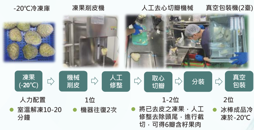
圖7.鳳梨釋迦機械加工流程及人力配置
