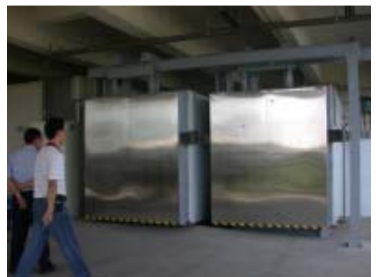
雙槽輪流使用的真空預冷機提高處理效率
