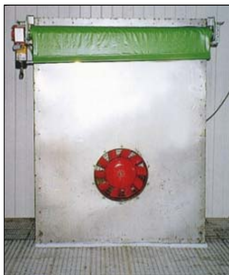
移動式壓差預冷設施
