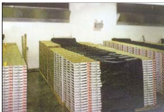
大型隧道式壓差預冷庫操作情形 (Thompson et al., 1998)
